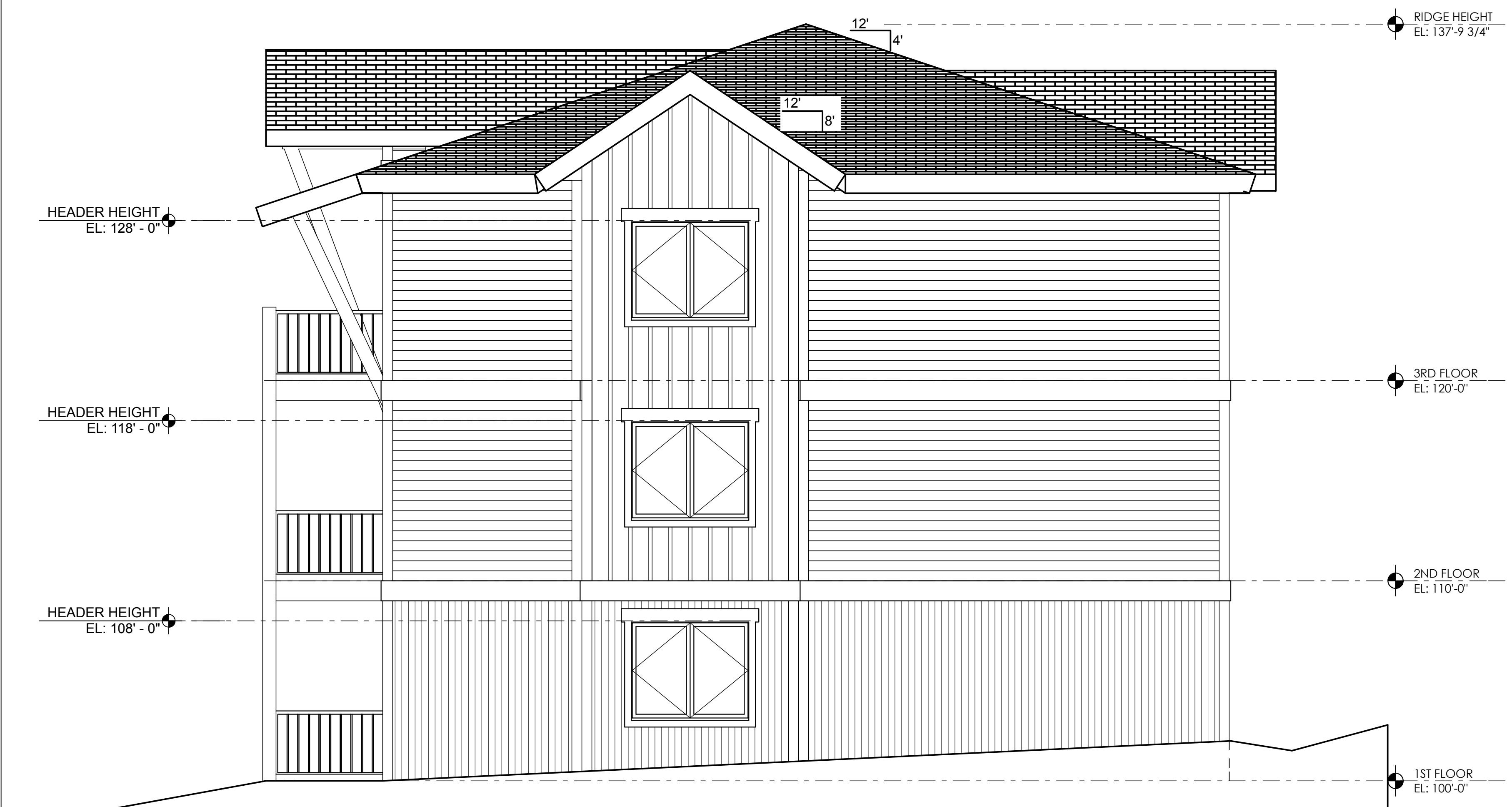
2 SIDE ELEVATION SCALE: 1/4" = 1'-0"
